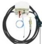
Centrale de pulvérisation avec une lance en inox. Equipée d'une buse à jet plat. Vous avez le choix entre 16 dilutions différentes entre 0.5 % et 12 %. Raccord entre le pistolet et le tuyau de lavage. Pression de service entre 2 et 6 bar.
